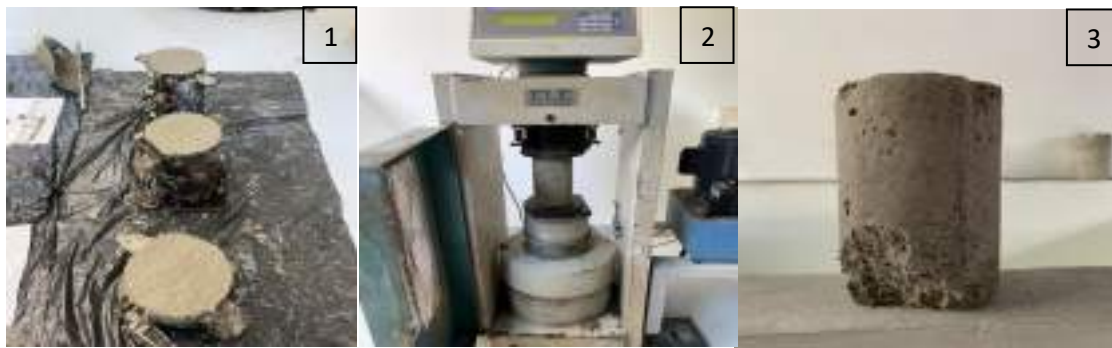
Figura 1 Ensayo de resistencia a la compresión
