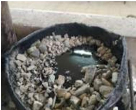
*Nota.* La mezcla de agregados y asfalto fue realizada a temperatura 160 °C.
