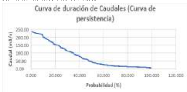
Figura 2 Curva de duración de caudales
